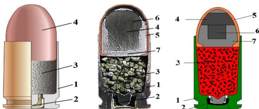
Розрізи 9 мм пістолетного патрона та його будова
